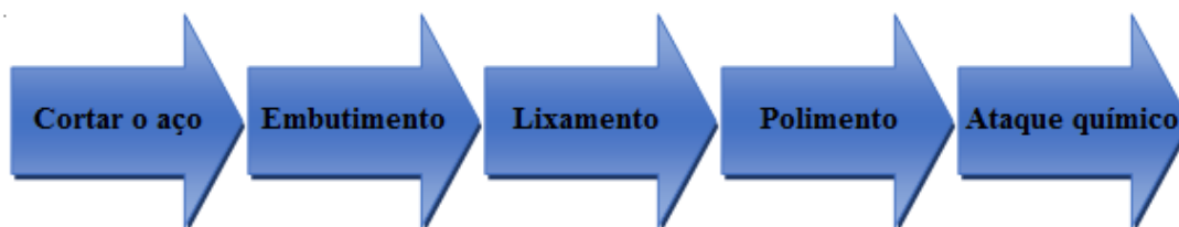
Figura 1 – Fluxograma da preparação das amostras de aço para microscopia.
